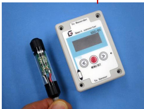
図-4 アナログ出力型コンバータ GSC-01
