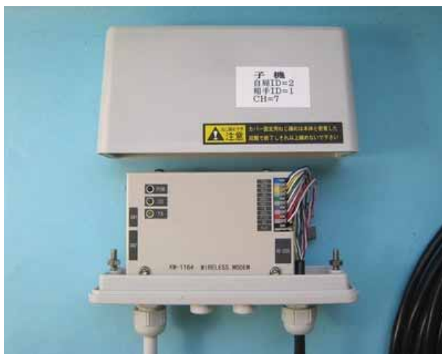
写真 - 1 屋外用ケースへの収納状況
