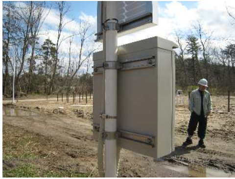
写真-5 ボックスの単管固定クリップ
