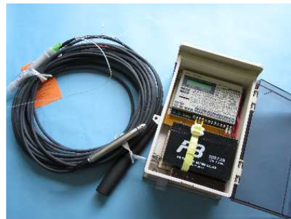
写真-2 水位計とロガー・バッテリーの組合
