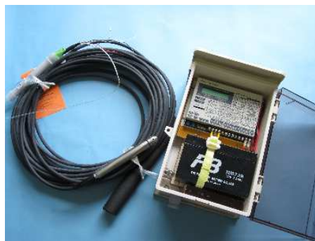
写真-2 水位計とロガー・バッテリーの組合
