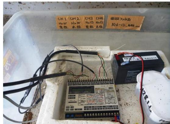
4CH データロガー (沈下2点+水位2点)
