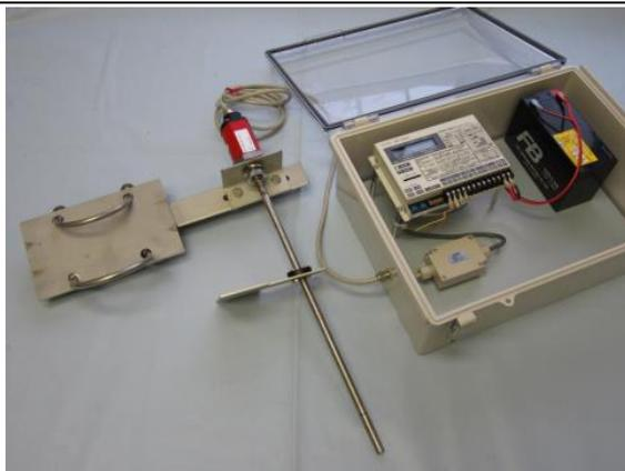
変位計の取り付け金具と計測ロガー
