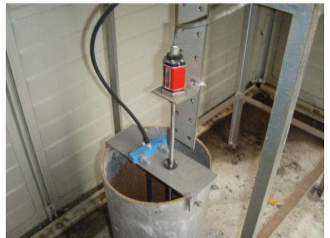
簡易的な地盤沈下観測架台
