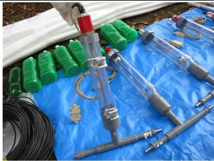
沈下計 本体（水槽、フロート、変位計）
