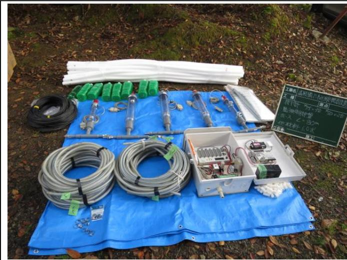
水管式沈下計 遠隔監視機材一式（5点計測）
