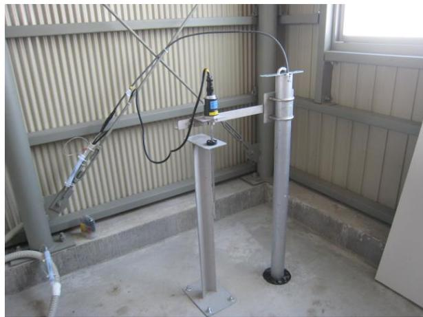
小型のロッド式沈下観測施設
