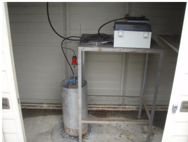
簡易的な沈下と水位の計測装置
