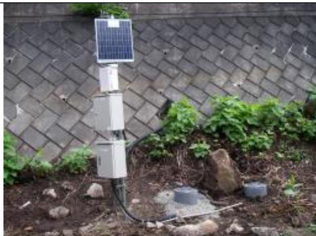
センサ機器の地下埋設例（耐積雪用）
