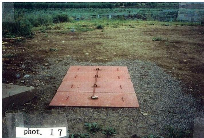
小型の地盤沈下観測井戸を地下ピットに収納した例
