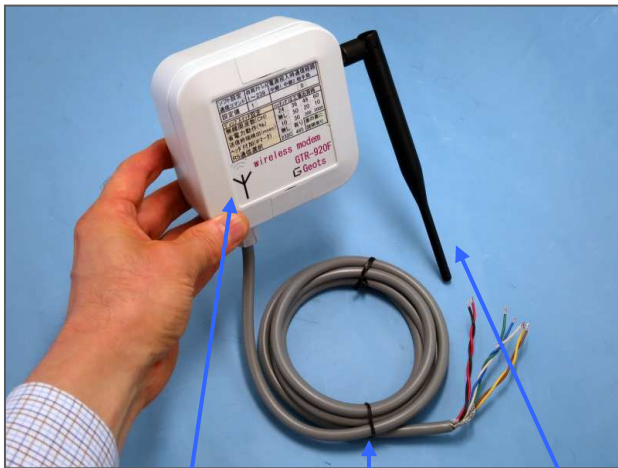
無線モデム本体 通信+電源・通信ケーブル アンテナ
