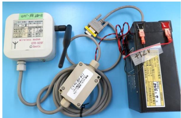
親機側：PC、USB-RS 変換、無線機、バッテリー
