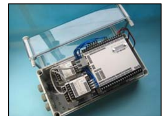
計測ボックスへの組込例(4CH 収納)
