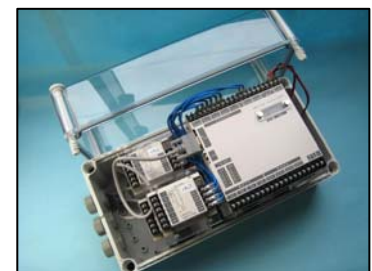
計測ボックスへの組込例(4CH 収納)
