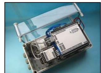
計測ボックスへの組込例(4CH収納)
