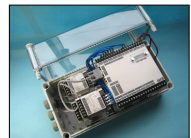
計測ボックスへの組込例(4CH収納)
