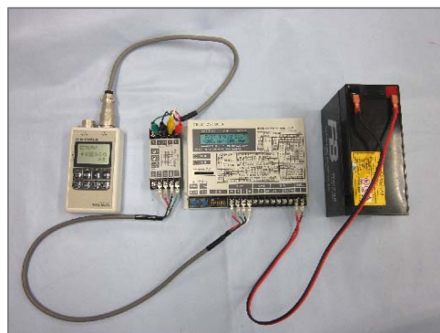
写真2 ひずみアンプとロガーの接続例 (標準ひずみ発生器でテスト中)
