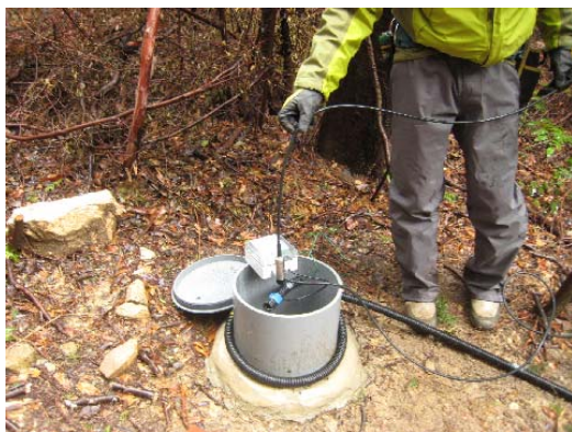
図-3 水位計の挿入状況
