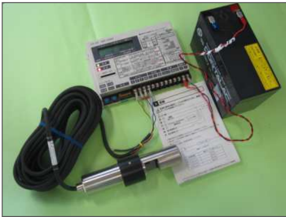
●濁度計 TC-3000 とロガーGTR-01A とバッテリー
